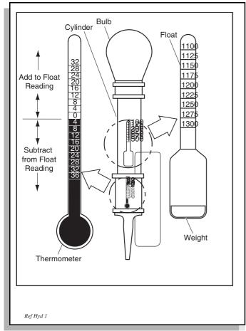
Fig. 30 Hydrometer
